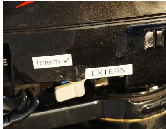
Vergrößerung Tank Umschalthebel, hier auf «Intern» gestellt
