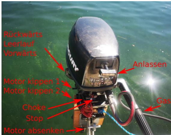
Funktionen des Aussenborders (Symbolbild: der Stopp-Knopf befindet sich beim Suzuki Motor hinten am Gasgriff)
