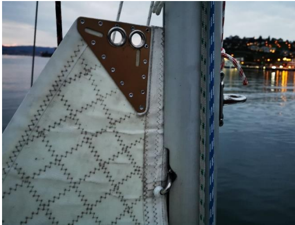
Grosssegel über die Einfädelhilfe mit den beiden weissen Kugeln in Mastprofil einfädeln
