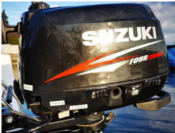
An bb des Motors befindet sich unten der Umschalthebel für internen und externen Tank
