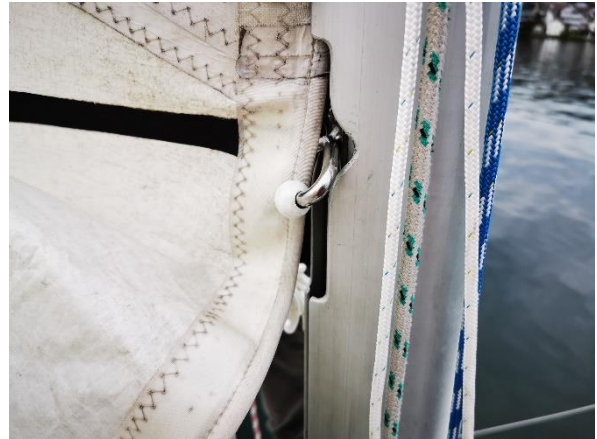
Beim Grosssegel-Setzen darauf achten, dass das Vorliek sauber einfädelt, dazu das Vorliek gegen Mast unterhalb der Einfädelhilfe drücken
