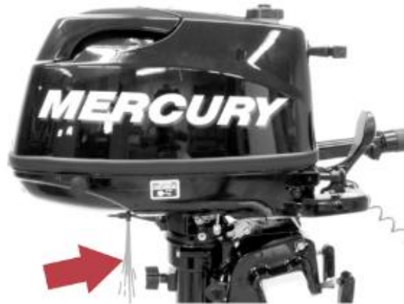
Kühlwasseraustritt achtern unter dem Motor (Symbolbild von Vorgängermotor)
